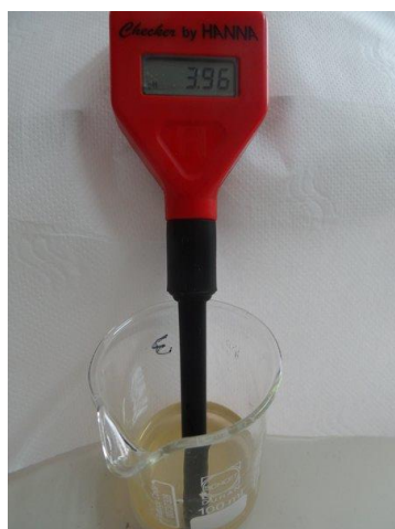
Slika 14: Merjenje pH-vrednosti jabolčnega soka Vir: osebni arhiv
