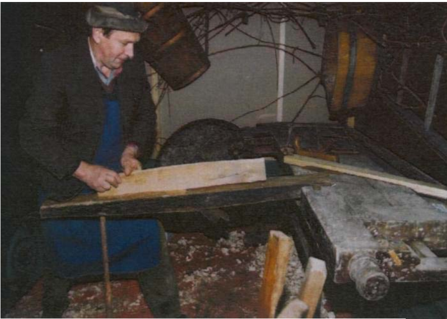
Sodar med obtesovanjem dog. (Foto: Baž Weiss)
