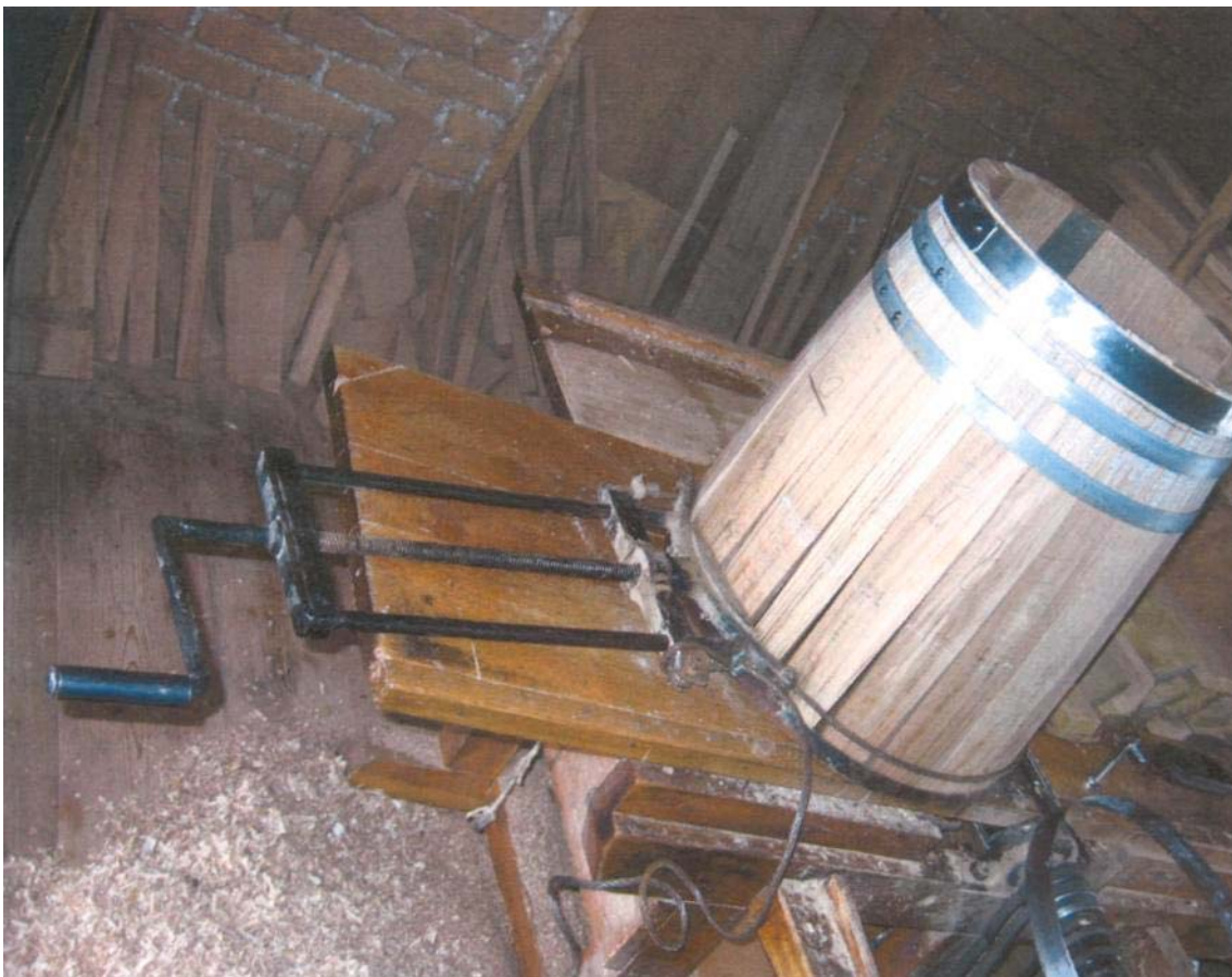
Stiskalnica za stiskanje dog je vpeta v širši rob soda. (Foto: Matija Matjaž)
