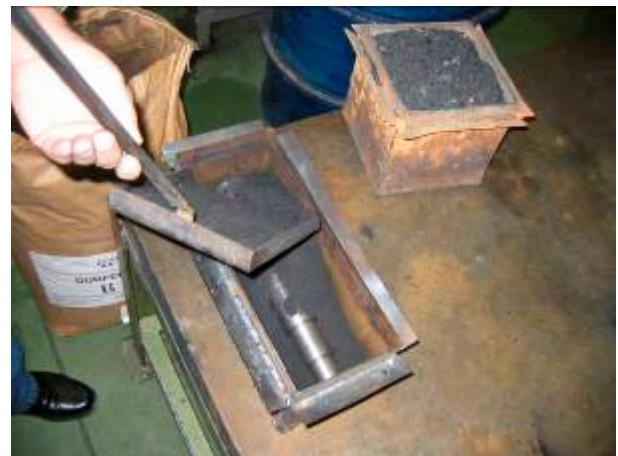
Slika 16: Priprava škatle in zasipanje obdelovanca z granulatom
