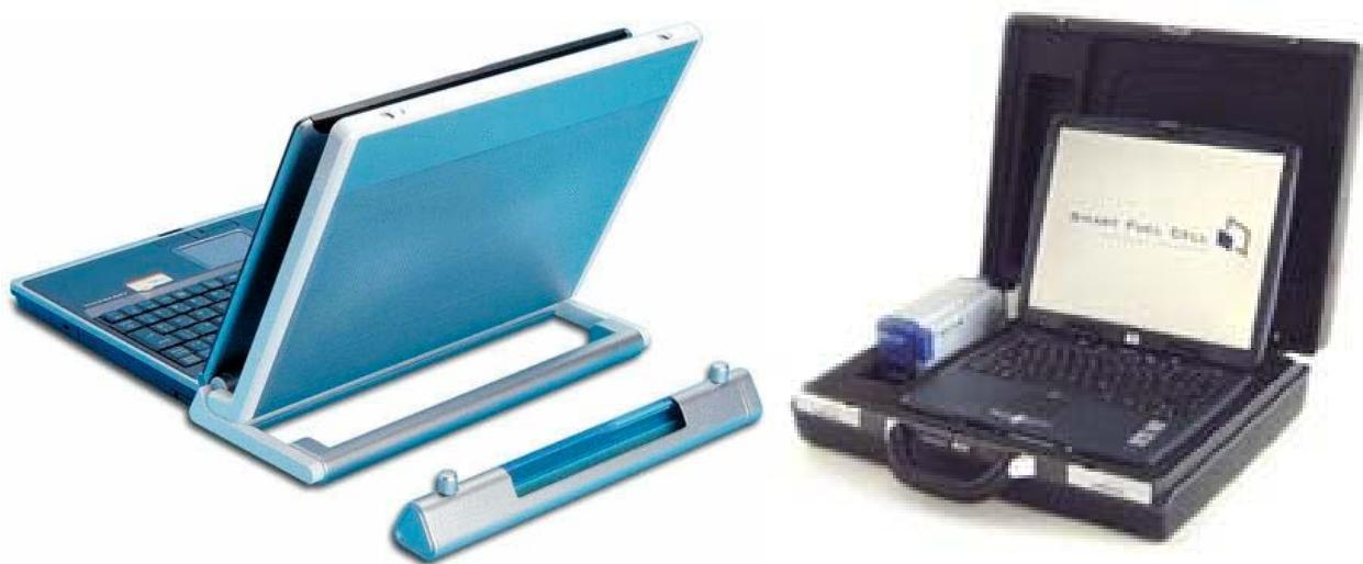
**SLIKA 21 IN 22:** Prenosna računalnika z napajanjem na gorivne celice.
