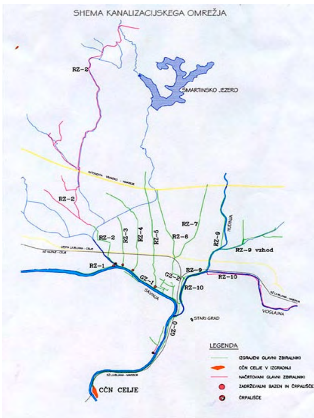
Slika 8: Shema kanalizacijskega omrežja
