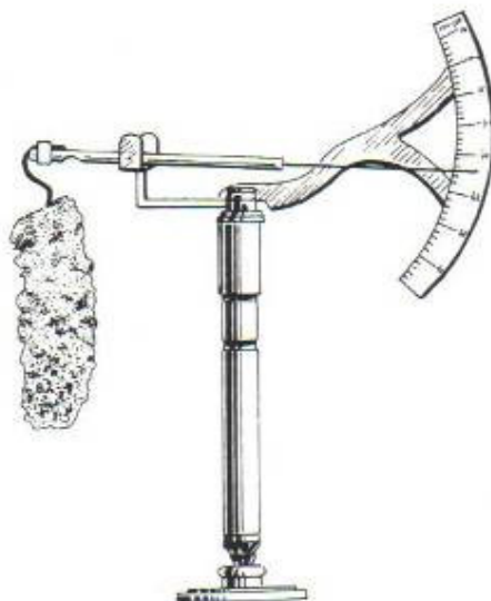
Slika 1: prvi znani merilnik vlage
