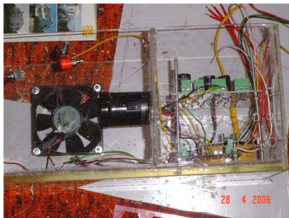
Slika 32: Vstavljanje vezij in priključnih puš.
