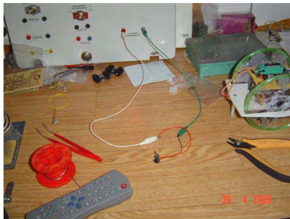
Slika 34: Preizkušanje IR oddajnika in sprejemnika.
