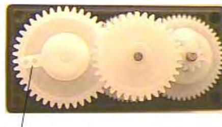
Slika 2: Zob, ki sem ga odščipnil in s tem omogočil popoln zasuk.
