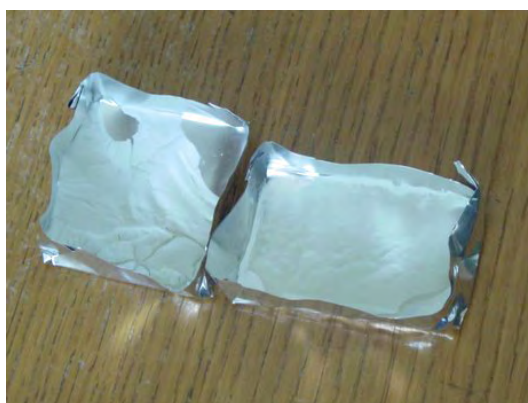
Slika 8: Primerjava vzorcev mikrokapsul brez veziva (na levi) in z vezivom (na desni)
