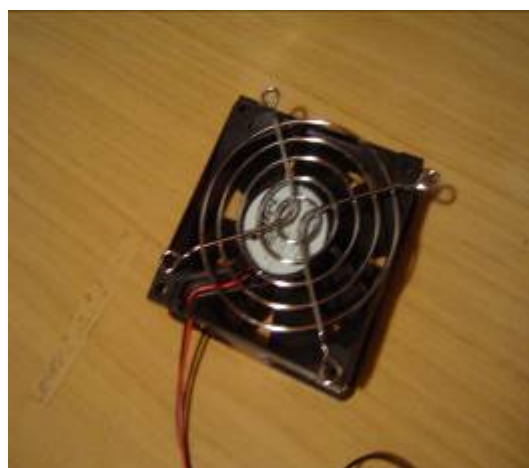
Slika 2: Ventilator za mešanje
