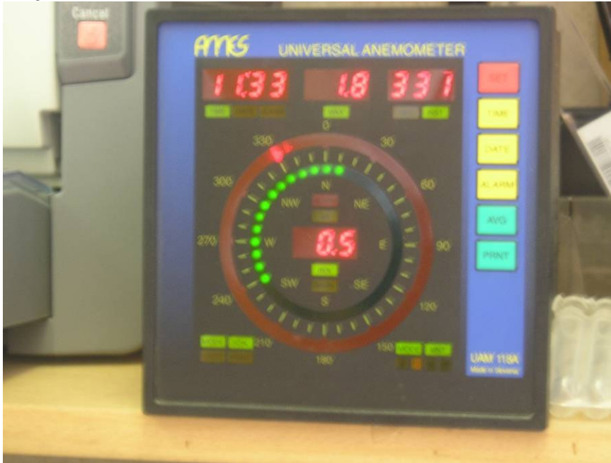
Fotografija 4: Aparat za odčitavanje smeri in hitrosti vetra na meteorološki postaji Celje
