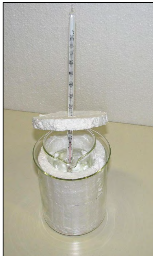
Slika 5: Eksperimentalna posoda z 1,5 cm ovojem iz polistirena
