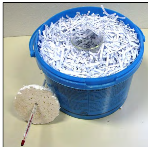
Slika 2: Eksperimentalna posoda z 8 cm ovojem iz papirja
