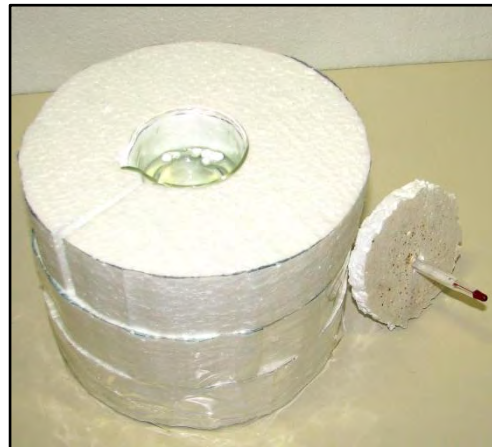
Slika 4: Eksperimentalna posoda z 8 cm ovojem iz polistirena
