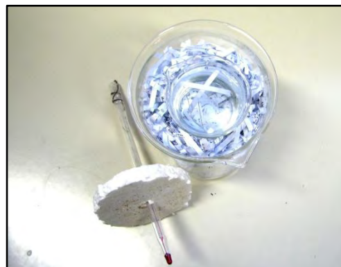
Slika 3: Eksperimentalna posoda s 3 cm ovojem iz papirja
