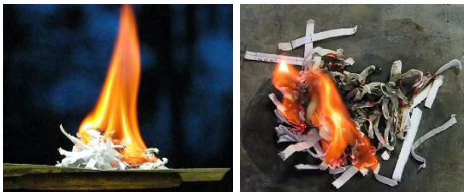
Slika 6: Gorenje papirnih kosmičev pred impregnacijo
