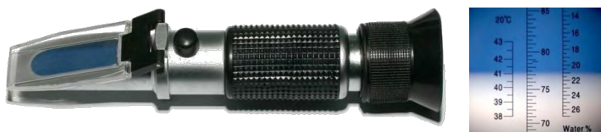
Slika 2: Refraktometer in njegova merilna skala
