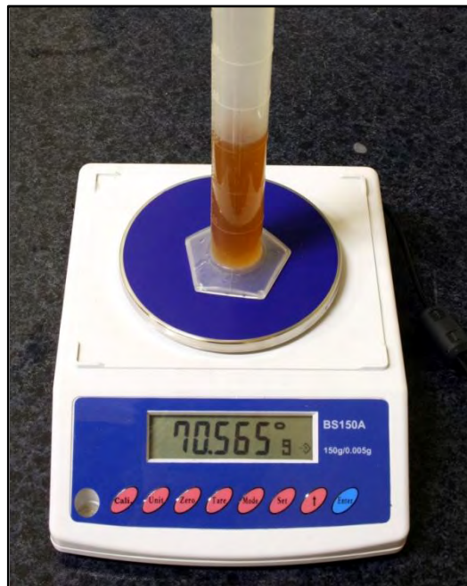
Slika 1: Merjenje mase medu za potrebe računanja njegove gostote
