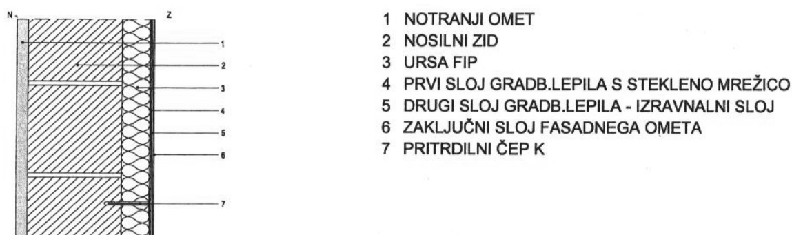
Slika 7: Zgradba zunanjsega zidu objekta A
