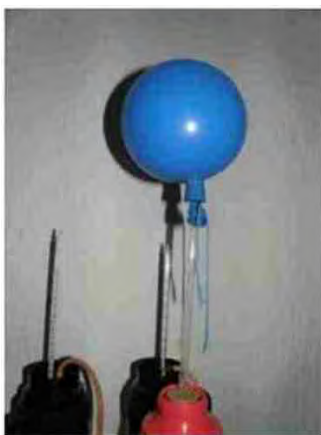
Sliki 8, 9 : Merjenje volumna CO 2 in temperature med fermentacijo
