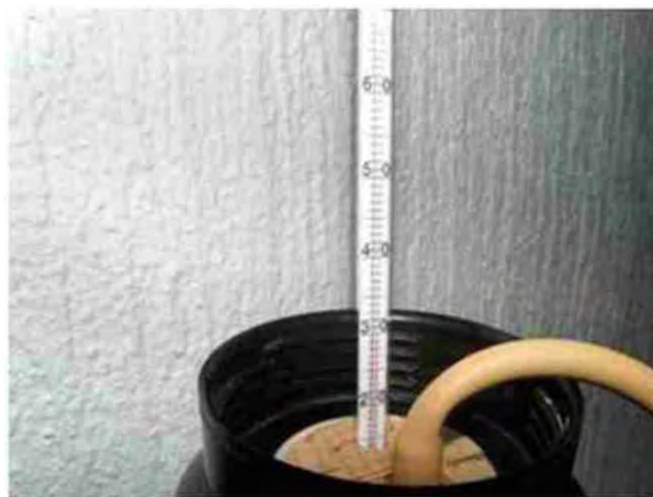
Sliki 8, 9 : Merjenje volumna CO 2 in temperature med fermentacijo
