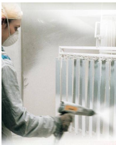
Slika 7: Nanašanje praškastega laka 9
