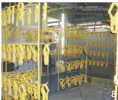
Slika 8: Pečenje izdelkov, zaščitnih z Ekolakom 12
