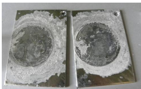
Slika 28: Vpliv na pocinkano površino 34
