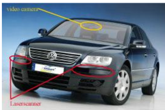
Slika 27: Namestitev senzorjev in video kamere ter prikaz stanja v vozilu
