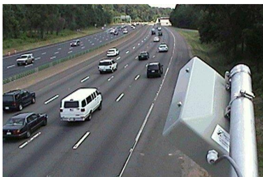
Slika 23: SAS-1 senzor (levo) in zanke za zaznavanje vozil (desno)
