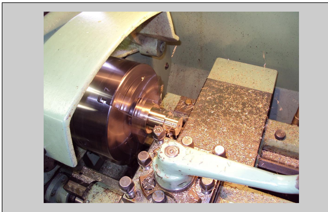
Slika 41: Grobo struženje vodila
