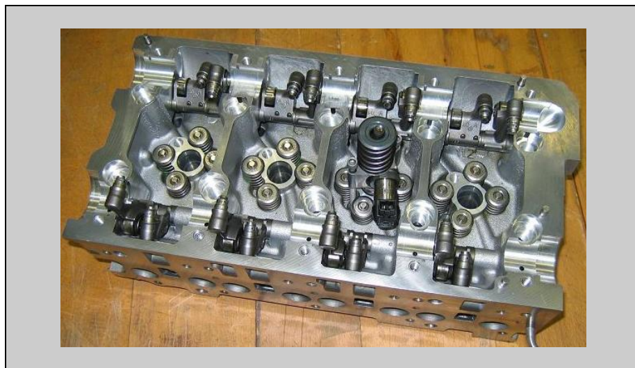
Slika 1: VW-glava dizel motorja, s komercialno oznako TDI, z delovno prostornino 1900 cm 3
