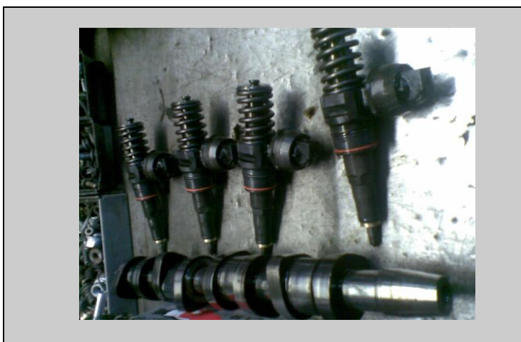
Slika 10: Odmična gred z vbrizgalnimi elementi
