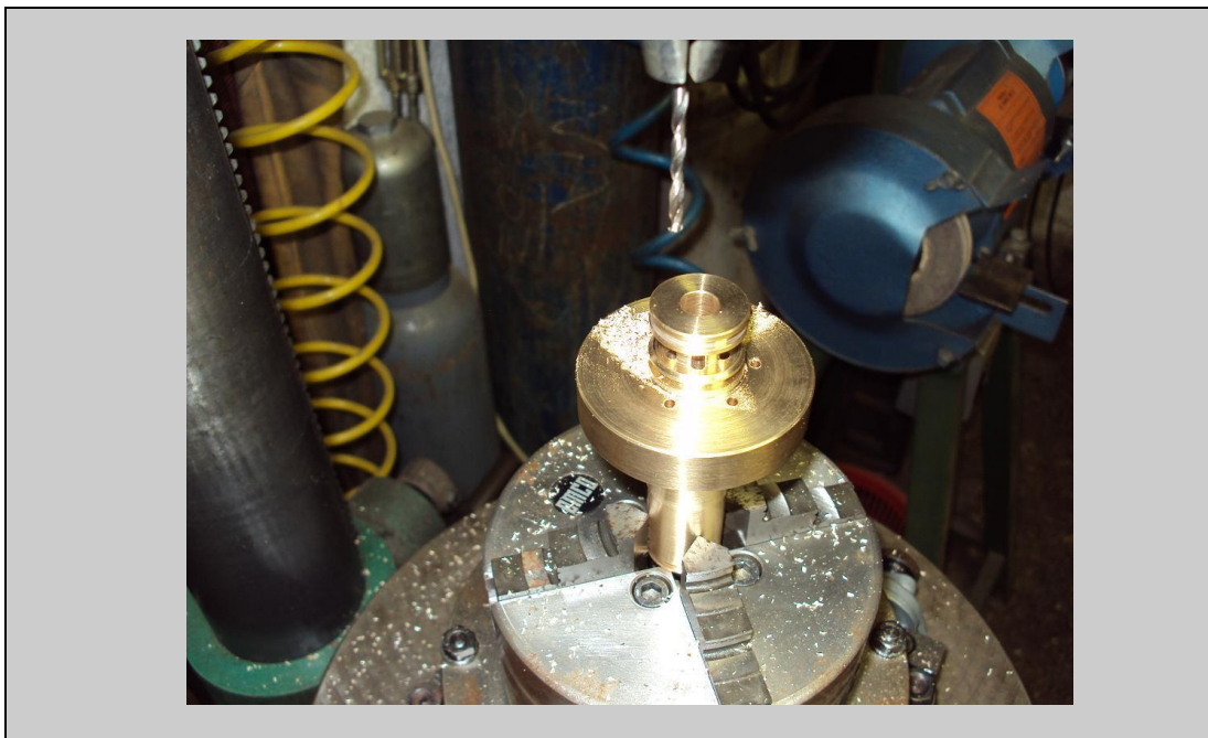
Slika 46: Vrtanje izvrtin za navoj M3
