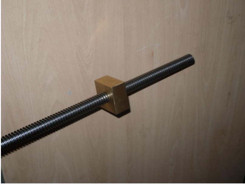
Slika 35: Izdelana vreteno in matica
