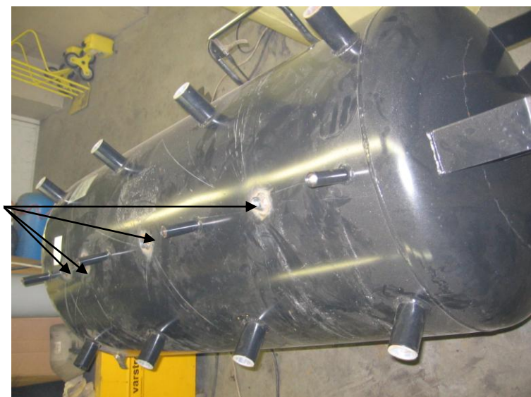
Slika 33: Privarjene dodatne navojne puše
