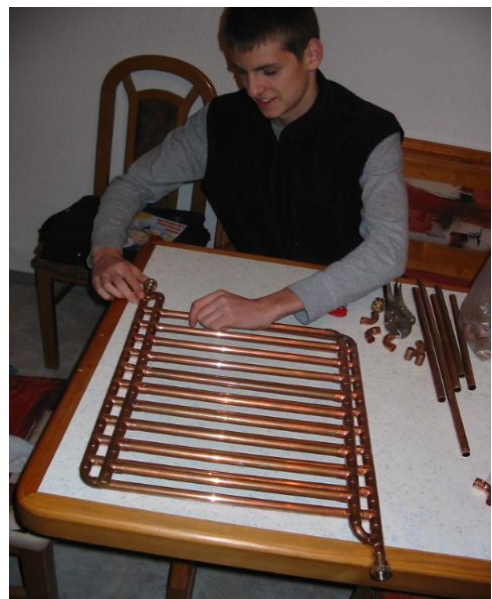
Slika 21 in 22: Sliki prikazujeta sestavljanje kolektorja iz bakrenih cevi
