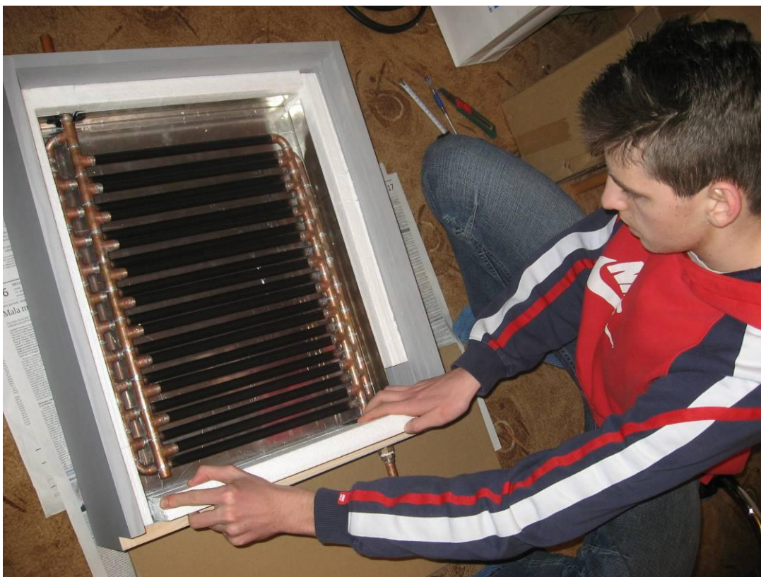
Slika 28: Nameščanje kolektorja v ohišje in montaža stiroporne toplotne izolacije
