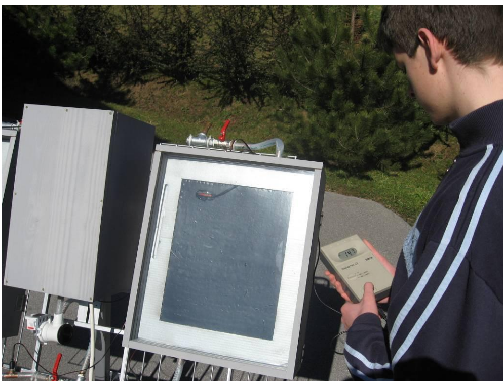
Slika 34: Meritve temperature in preverjanje temperaturnih senzorjev PT100
