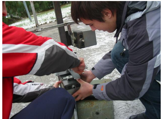
Slika 4: Nameščanje drugega servomotorja
