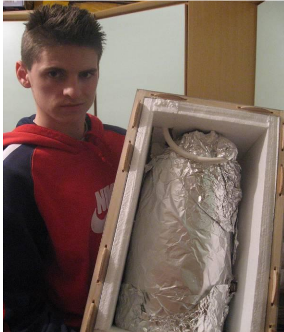
Slika 30: Sestava in vgradnja 8,5 l toplotnega zbiralnika vode
