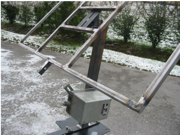
Slika 3: Ploščad in nameščen prvi servomotor
