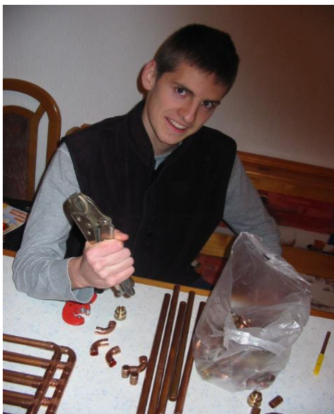
Slika 21 in 22: Sliki prikazujeta sestavljanje kolektorja iz bakrenih cevi
