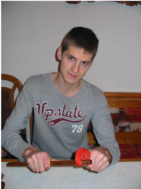
Slika 19 in 20: Sliki prikazujeta pripravo cevi in rezanje bakrenih cevi s posebnim orodjem
