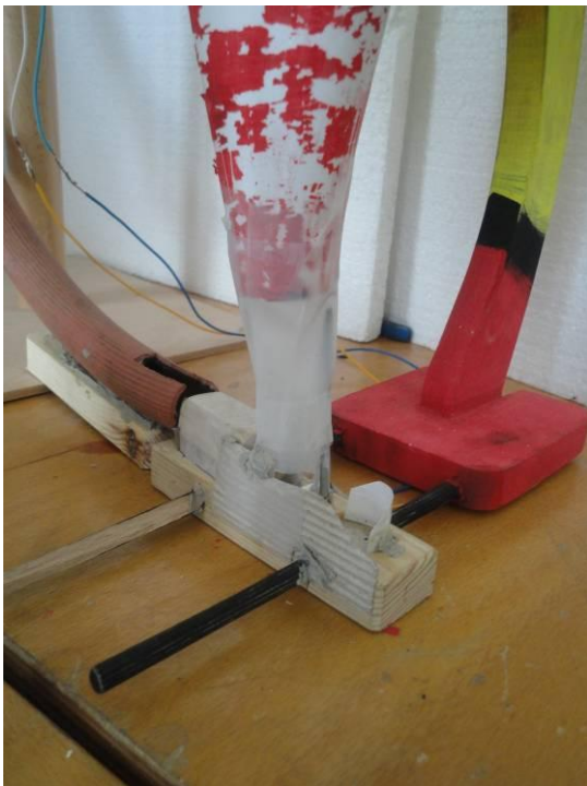
Slika 27: ujeta kroglica pade na stikalo
