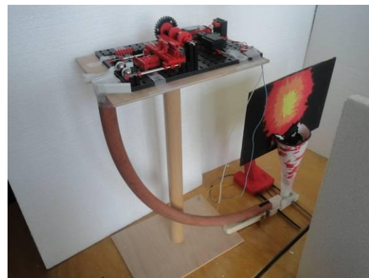
slika 28 : sklenjen električni krog požene magnetni boben
