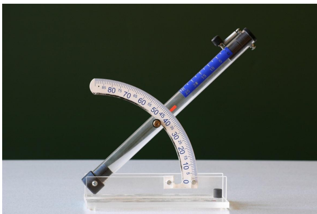
Slika 4: Top z vijačno vzmetjo za poševni met
