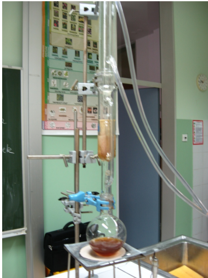
Slika 12: Soxhletov aparat, v katerem sva pridobivali vse štiri vrste eteričnih olj.
