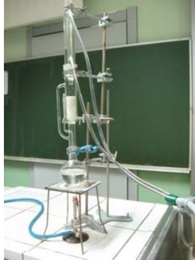
Slika 10: Namestitev tulca in sestava aparature
