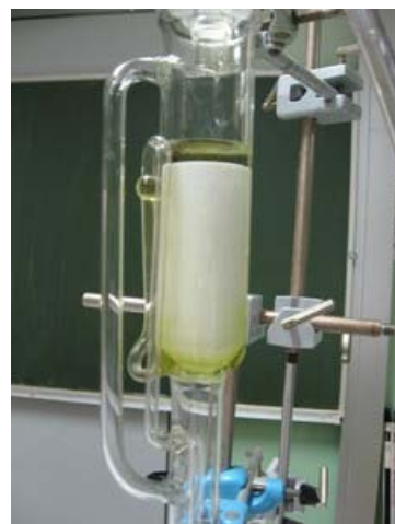
Slika 11: Zbiranje kondenziranega etanola v Soxhletovem aparatu
