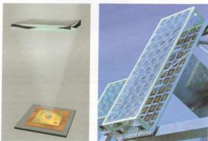
Slika 18: Prototip modula, ki uporablja leče (26)
