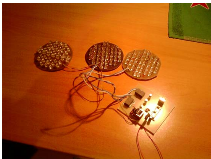
Slika 7: Vezje semaforja z lučmi
