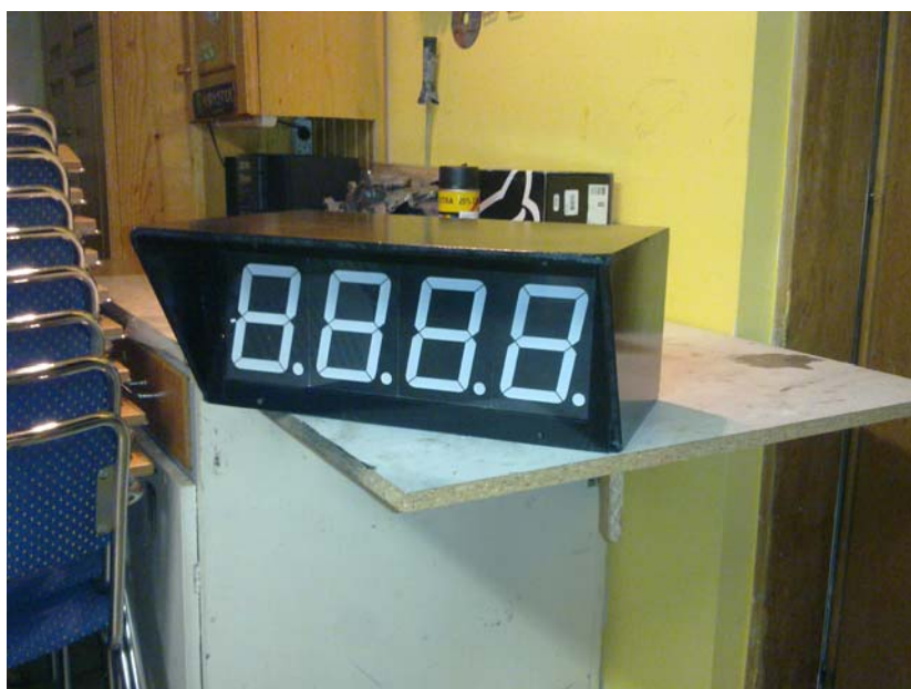
Slika 26: Dokončano ohišje časovnika
