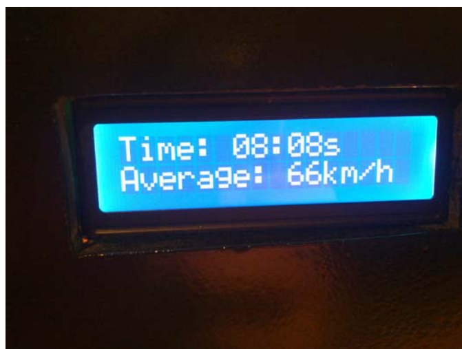
Slika 17: Izpisan čas in hitrost na LCD-ju
