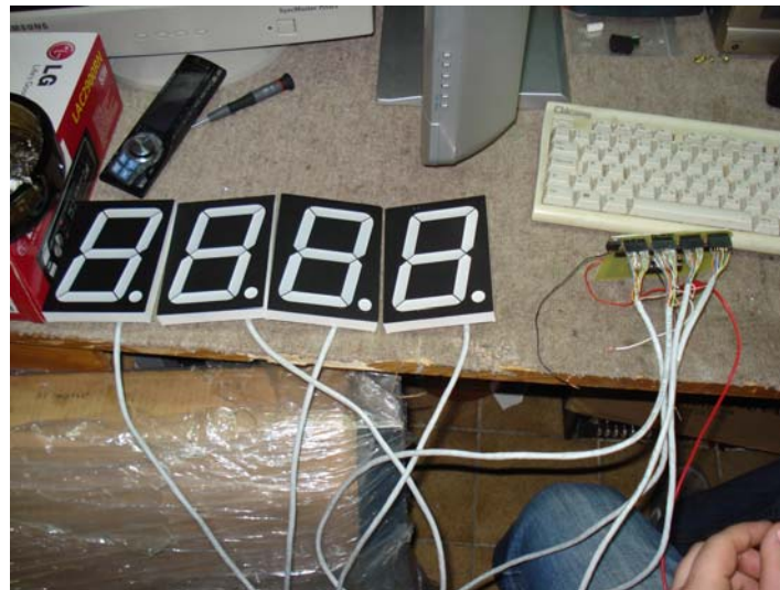
Slika 12: Povezani prikazovalniki z vezjem
