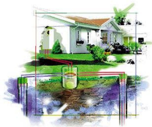
Slika 23: toplotna črpalka na vodo
