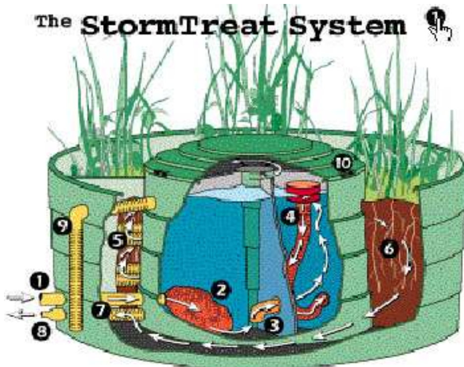
Slika 35: mala čistilna naprava
