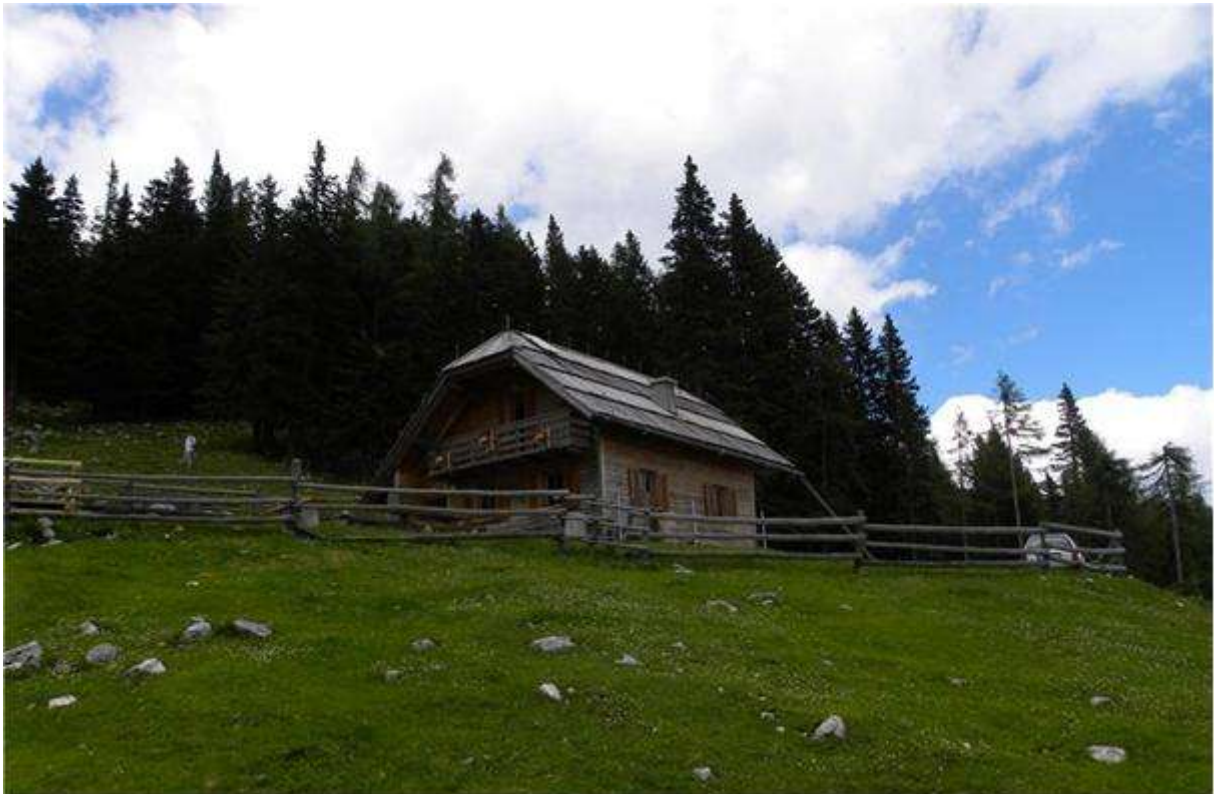
Pastirska koča na Podvežaku, v celoti grajena z lesom, ter pokrita z »šikelni«.
