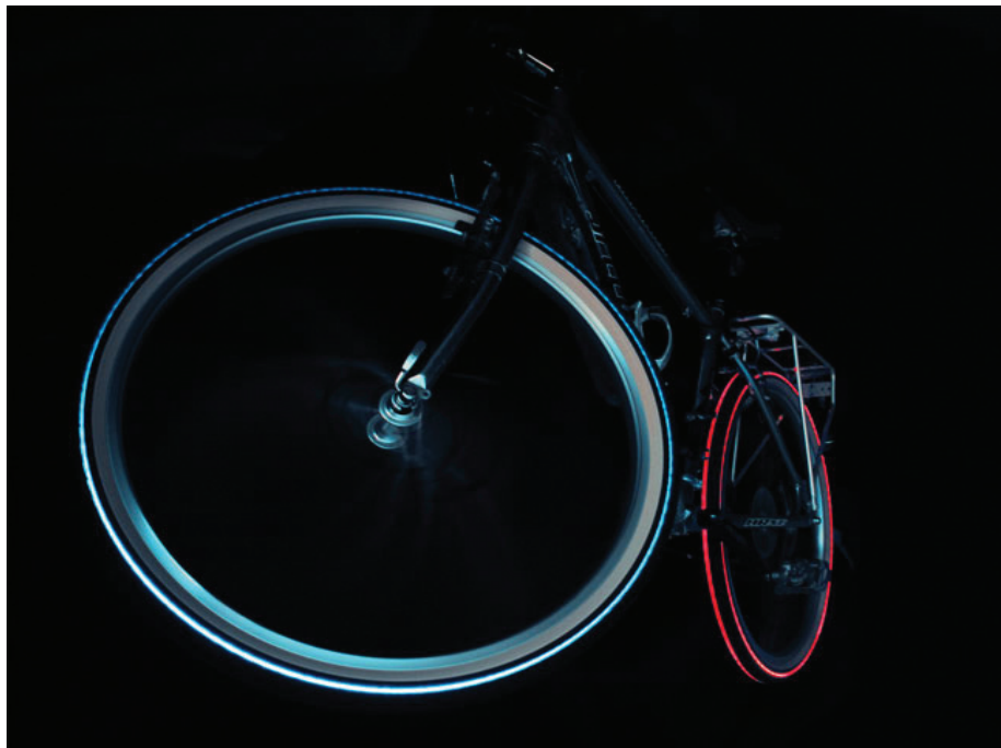
Slika 5 Night Bright pnevmatika: LED luči so vgrajene neposredno v pnevmatiko in med vrtenjem ustvarjajo iluzijo barve, žareč krog. Ne le da so zanimive na pogled, ponoči nas ščitijo, saj smo na cesti dobro vidni.
