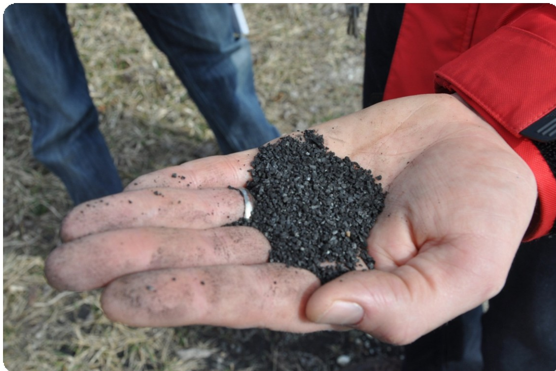
Slika 19: aktivno oglje iz ogljenih filtrov (avtor: Matija Del Negro)
