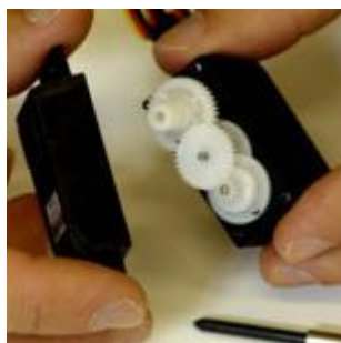
slika 2.15: Zobniki v zgornjem delu servo-motorja.
