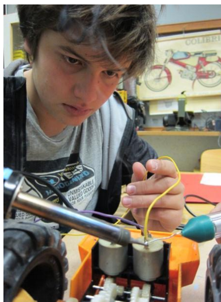
slika 3.4: Spajkanje žica na motorja.
