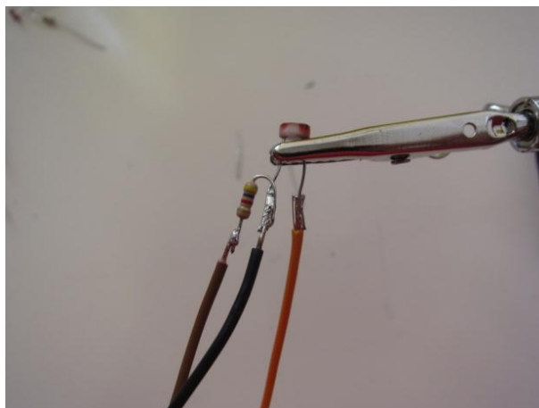
slika 3.5: Izdelava delilnika napetosti s fotouporom.
