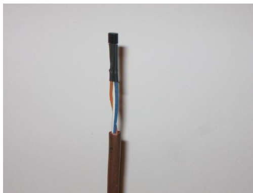
Slika 22: LM35 v bakreni cevi (Avtor: Simon Stiplovšek, 2012)
