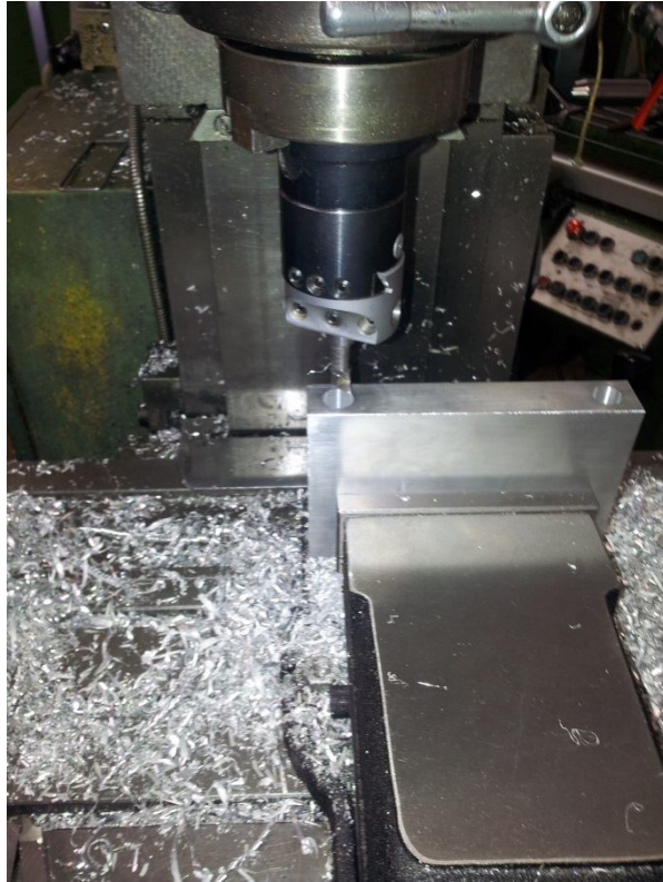
Slika 26: Izdelava lukenj za ležajne puše z izstružilno glavo
