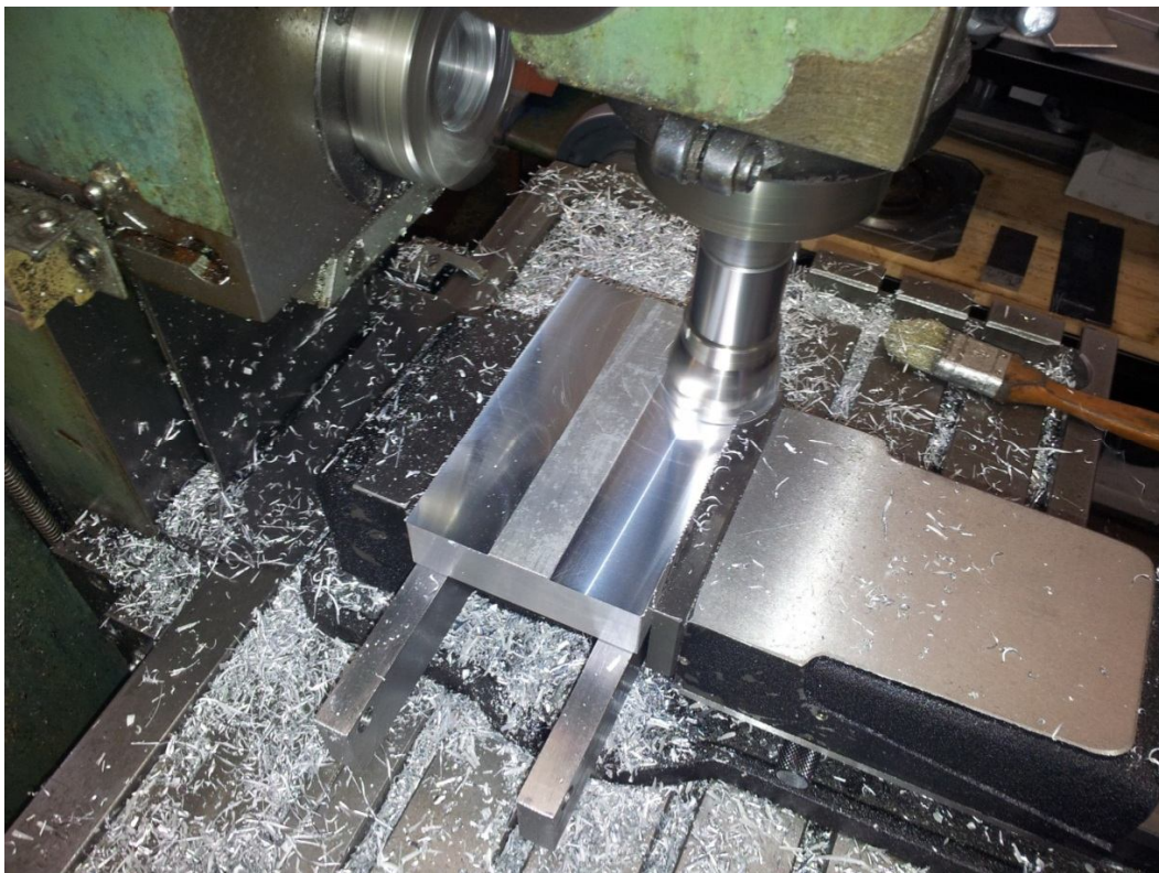
Slika 25: Izdelava pomične plošče z ležajnimi pušami
