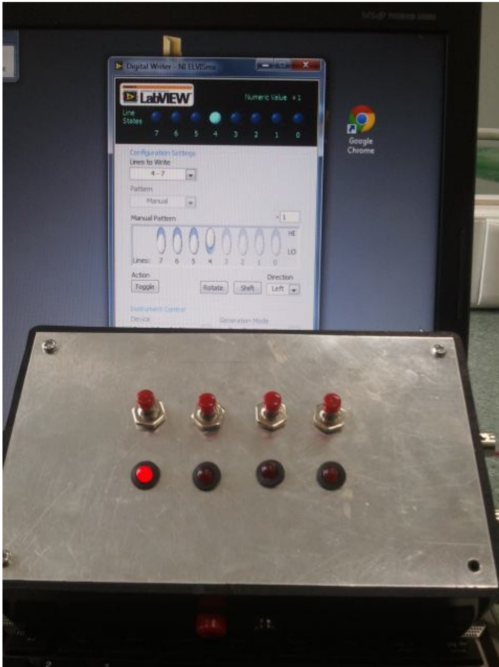
Slika 6.36: Setiranje digitalnega izhoda
