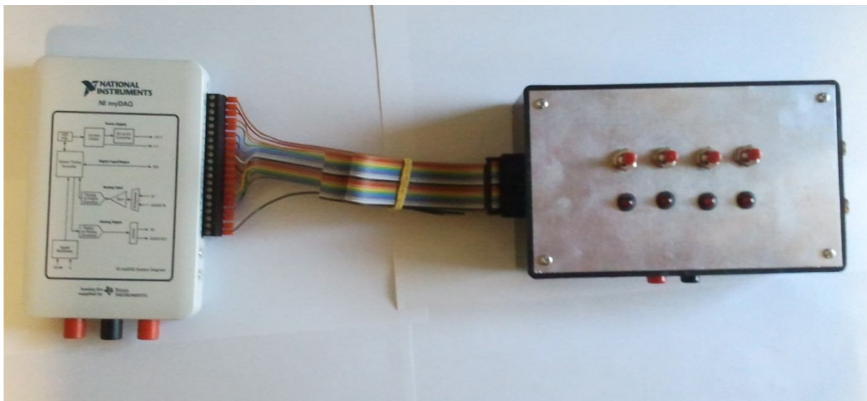
Slika 2.1: Naprava MyDAQ in vmesnik
