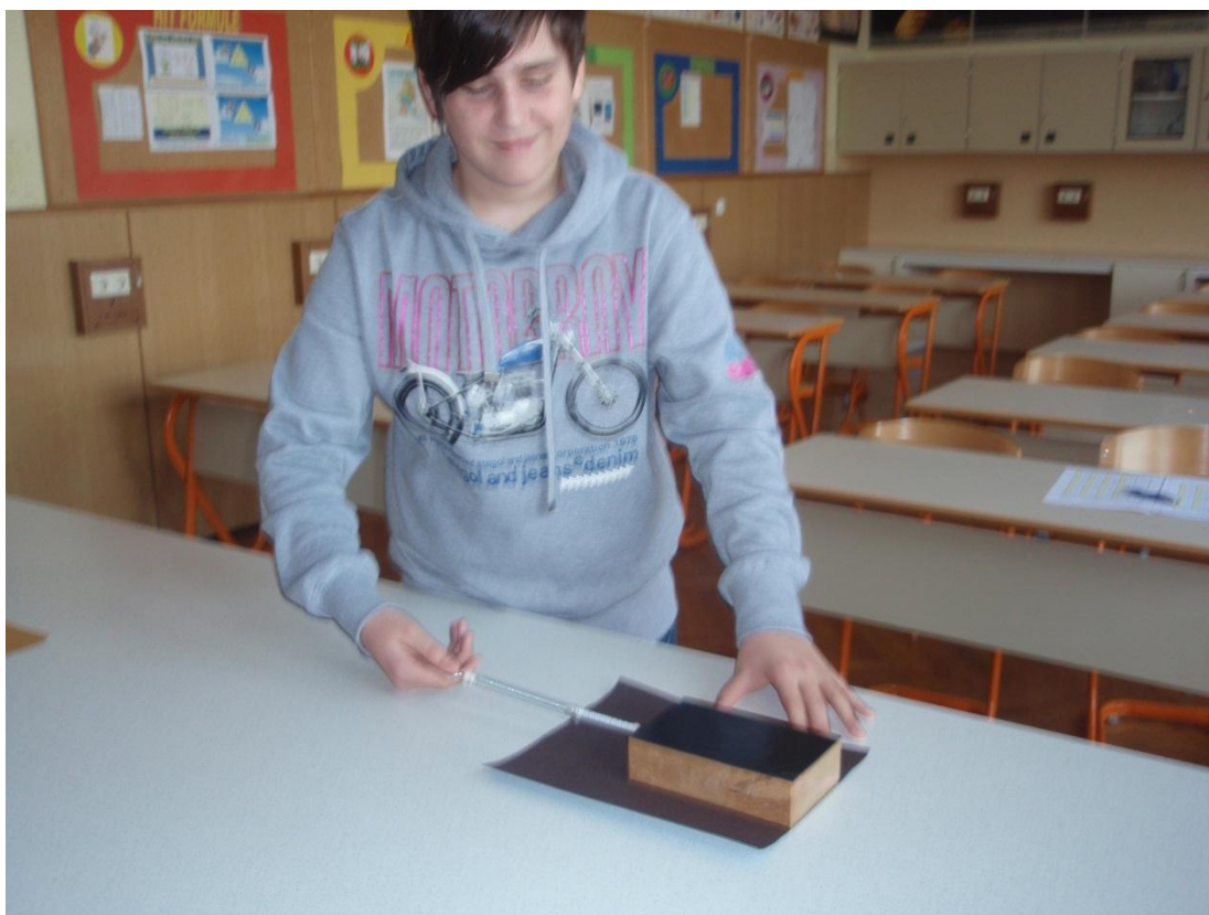
Slika 7: Merjenje sile lepenja pri vleki kvadra s silomerom
