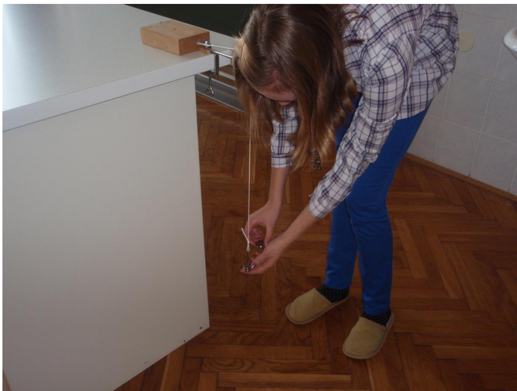
Slika 10: Merjenje sile lepenja pri vleki kvadra z utežmi preko škripca
