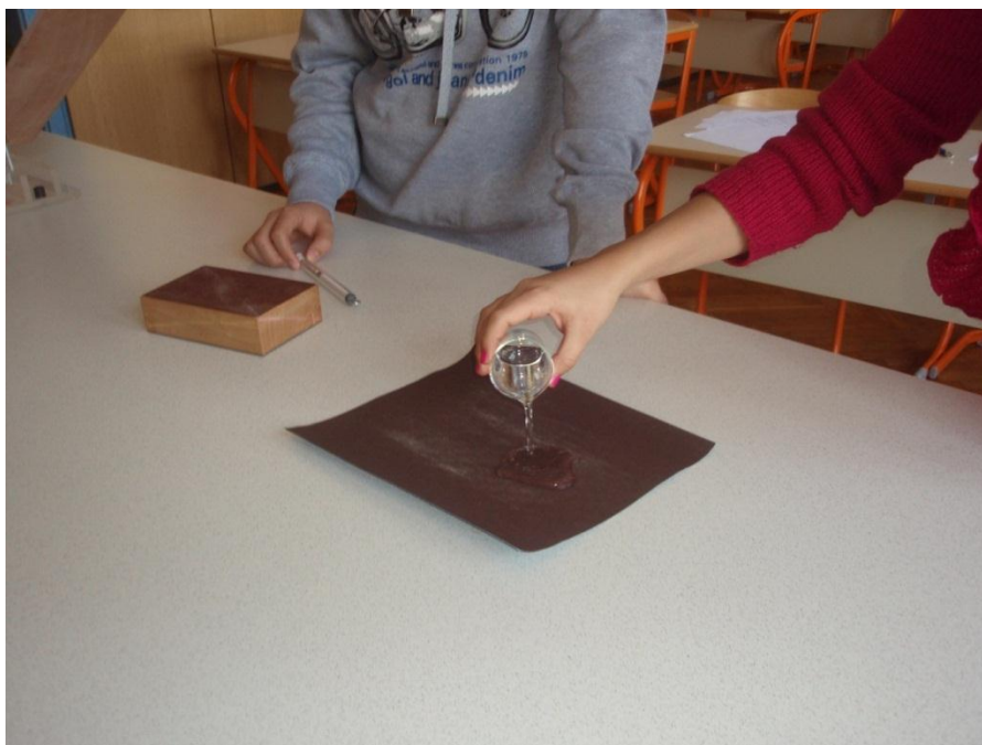
Slika 12: Priprava za merjenje sile lepenja na »mokri« podlagi
