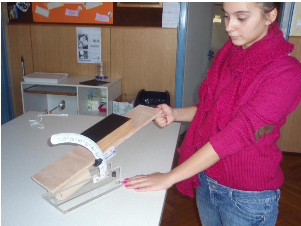
Slika 8: Merjenje sile lepenja pri spuščanju kvadra s pomočjo nagiba klanca
