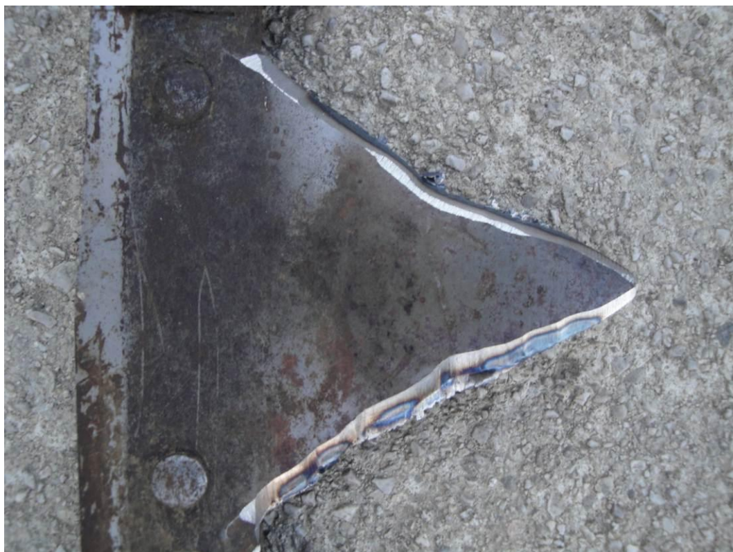
Slika 23: Primer napačno ostrenega noža (pregreta rezalna površina)
