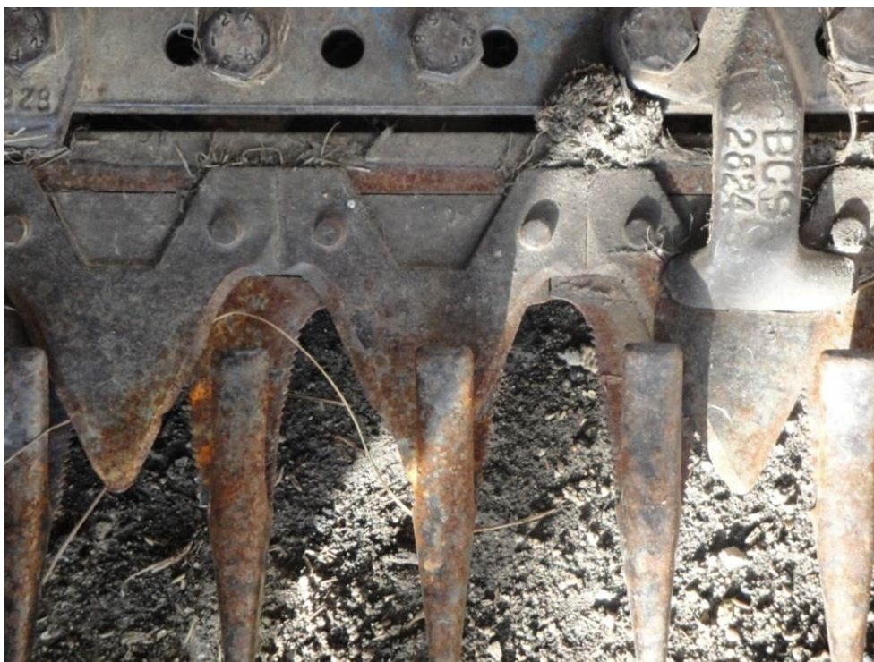
Slika 21: Izrabljen in zanemarjen kosilni greben
