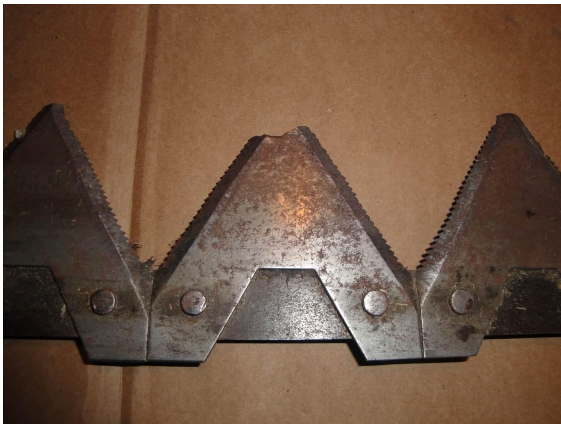
Slika 18: Zlom strižnega noža
