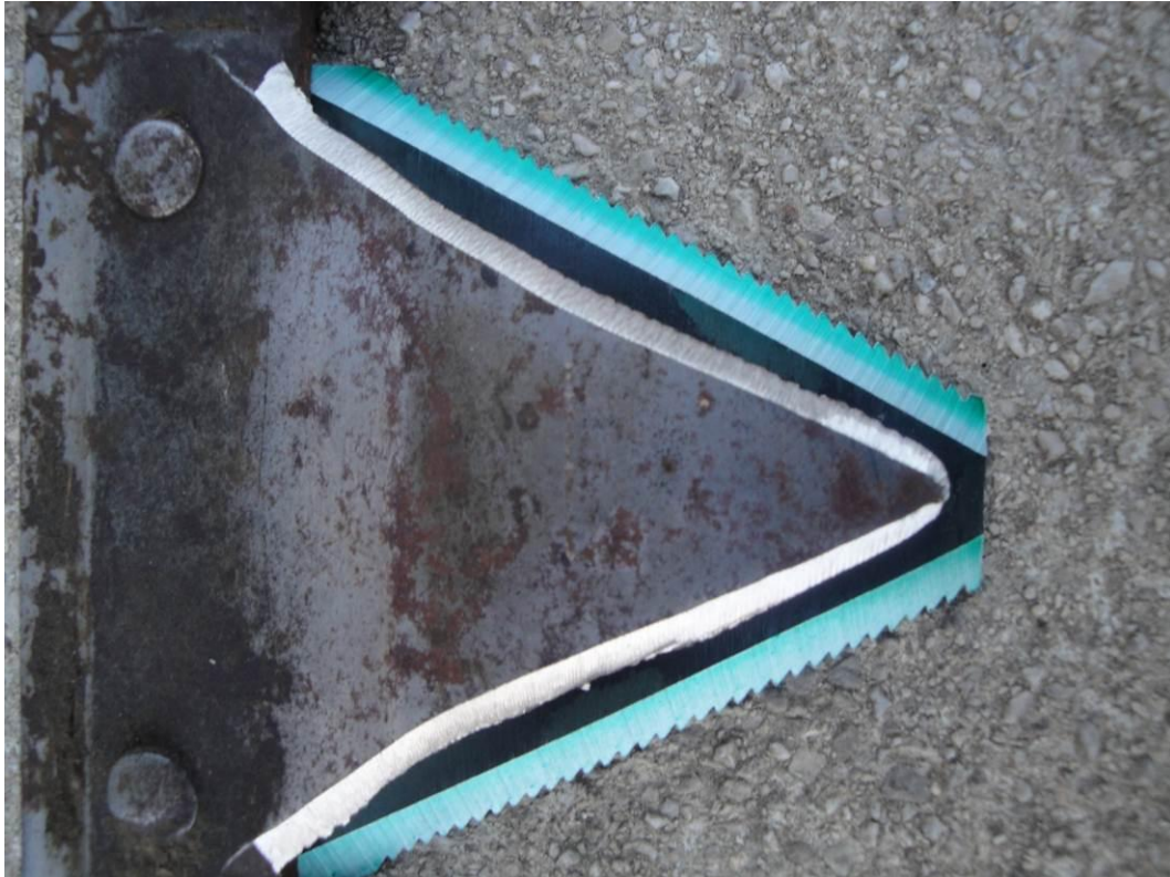
Slika 22: Primer napačno ostrenega strižnega noža (uničena rezalna geometrija)
