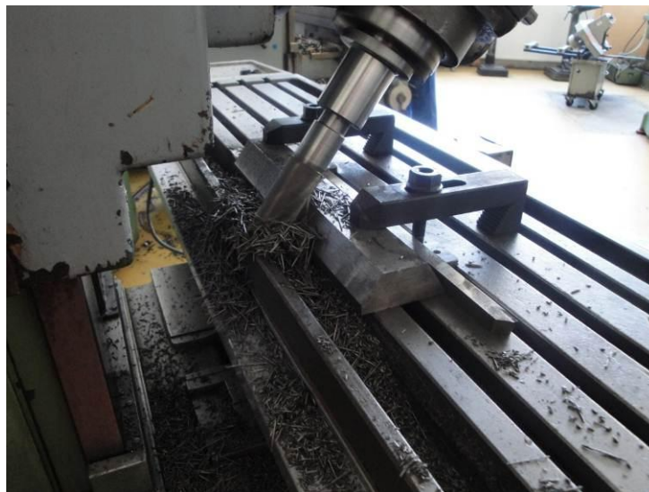
Slika 33: Končna obdelava na rezkalnem stroju
