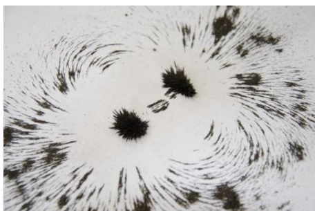
Slika 3.3: Silnice neodimijevega magneta.
