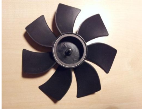
Slika 3.10: Rotor, vrteči se del našega ventilatorja.
