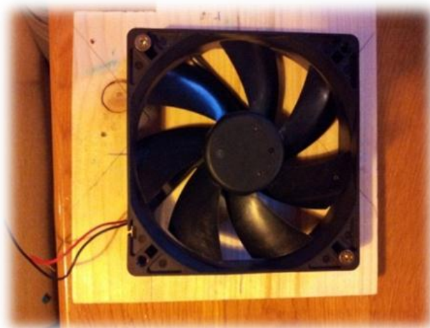
Slika 4.1: Ventilator brez magnetov in z razklenjenima sponkama.
