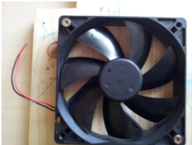
Slika 4.23: Ventilator brez magnetov, v kratkostični povezavi.
