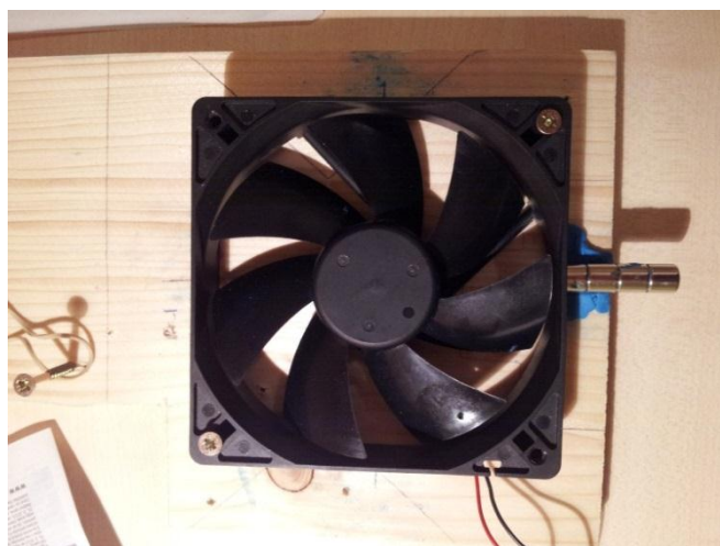
Slika 4.10: Ventilator s štirimi magneti v stolpcu, katerega severni pol je obrnjen proč od ventilatorja.
