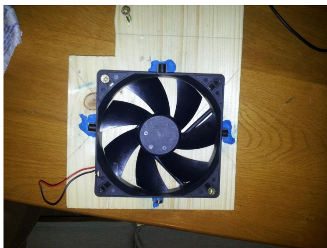
Slika 4.22: Ventilator s štirimi magneti, katerih južni pol je usmerjen proč od ventilatorja.
