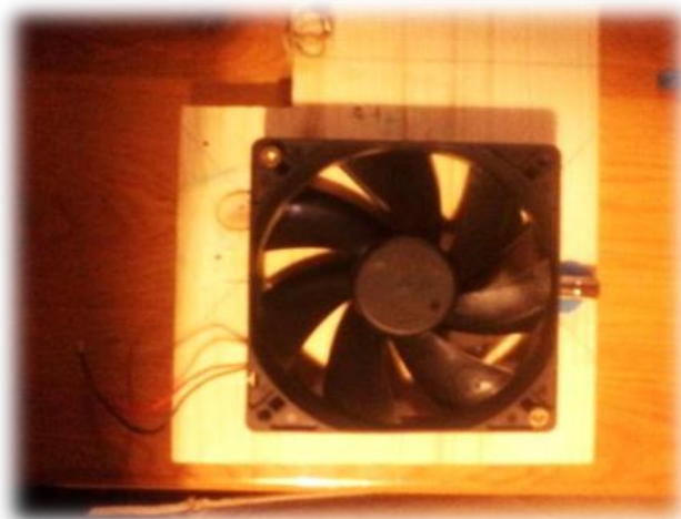
Slika 3.3: Ventilator z dvema magnetoma , katerih severni pol je usmerjen proč od ventilatorja.
