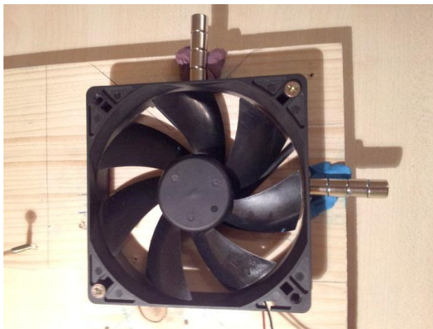
Slika 4.11: Ventilator z dvema stolpcema iz po štirih magnetov, katerih severni pol je usmerjen proč od ventilatorja.
