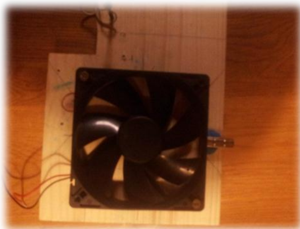
Slika 4.4: Ventilator s tremi magneti, katerih severni pol je usmerjen proč od ventilatorja.
