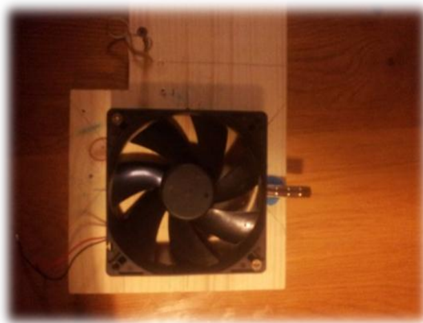
Slika 4.9: Ventilator s štirimi magneti, katerih južni pol je usmerjen proč od ventilatorja.
