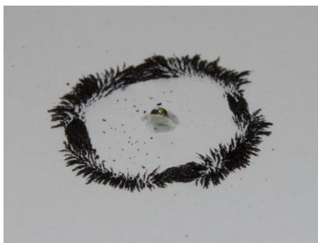
Slika 3.5: Silnice trajnega magneta – rotorja.
