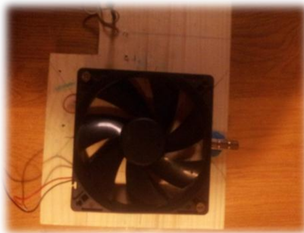
Slika 4.7: Ventilator z dvema magnetoma, katerih južni pol je usmerjen proč od ventilatorja.
