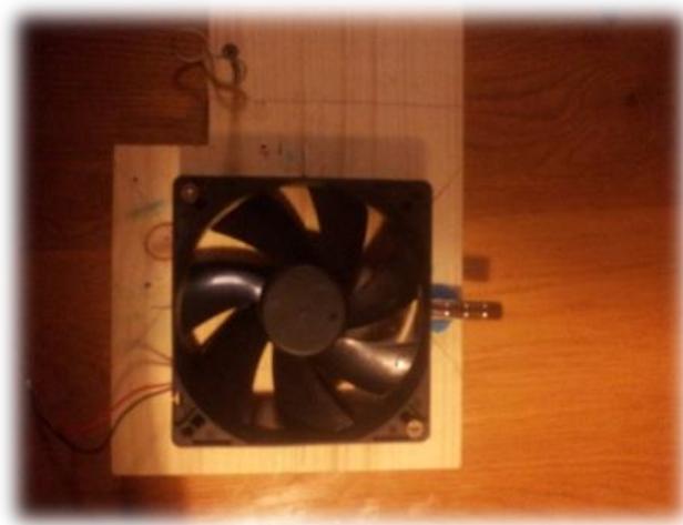
Slika 14: Ventilator z enim stolpcem iz štirih magnetov, katerega južni pol je usmerjen proč od ventilatorja.
