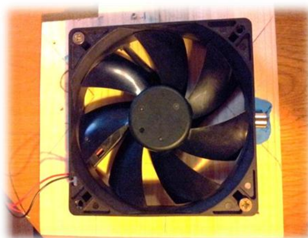
Slika 4.2: Ventilator z enim magnetom, ki ima severni pol usmerjen proč od ventilatorja.
