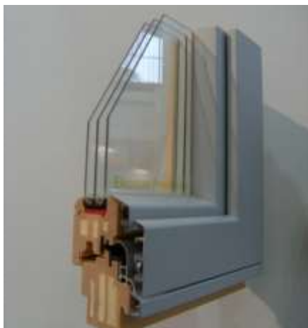
slika 9 Prerez lesenega okna v kombinaciji z aluminijem (vir: lastna slika)
