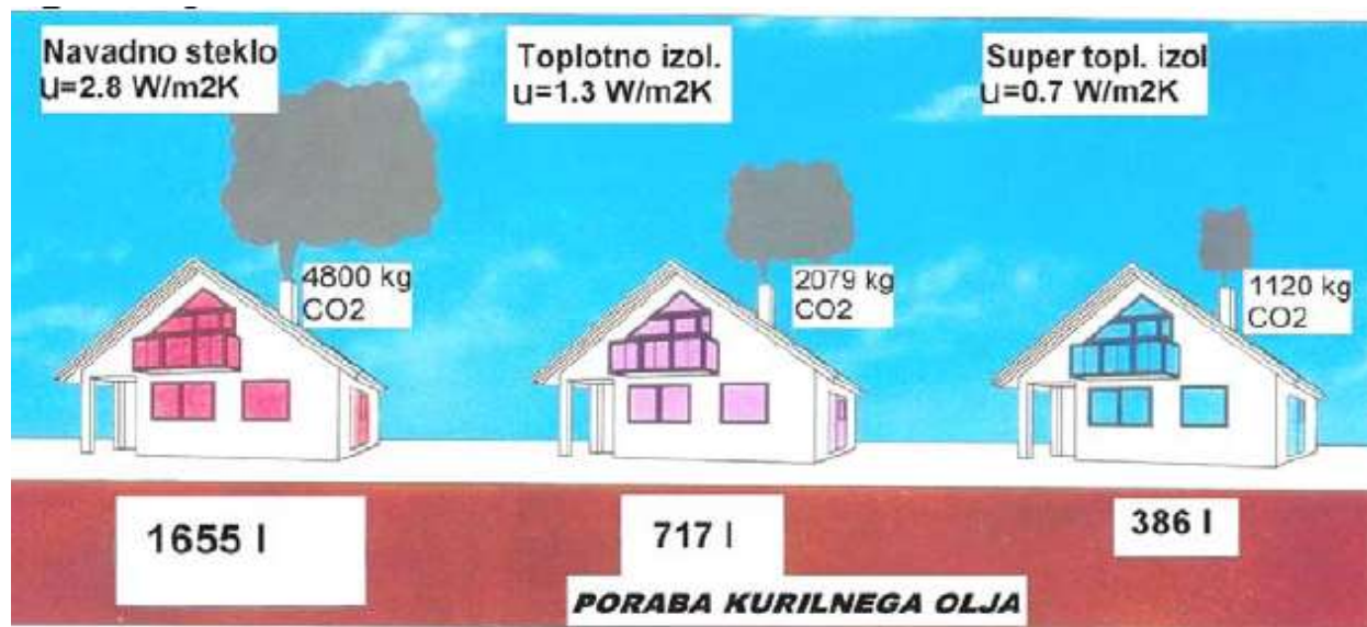
Slika 1 Primerjava porabe kurilnega olja glede na različne vrste zasteklitve (vir: Povzeto iz revije Delo in dom)
