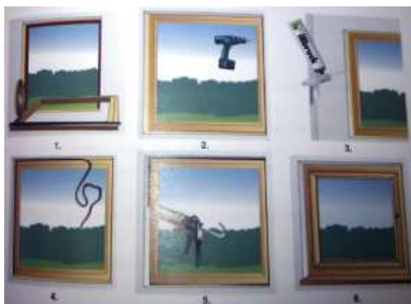
slika 16 Postopek gradnje okvirja po sistemu RAL (standardni sistem) (vir: lastna slika)
