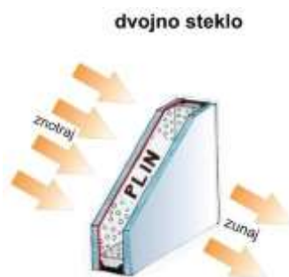
slika 4 Sestava dvoslojnega termoizolacijskega okna(vir: www.jelovica-okna.si )
