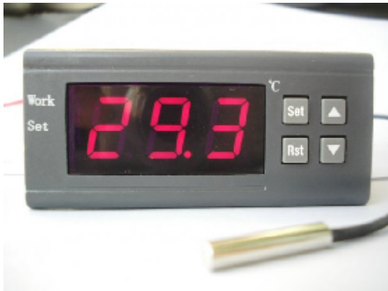
Slika 1: Temperaturni regulator ETC 100
