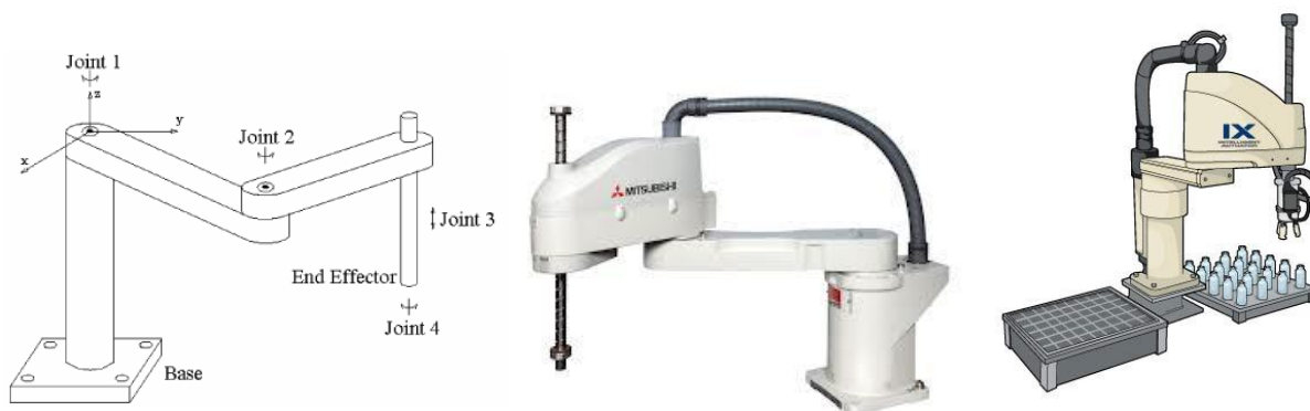
Slika 18: SCARA zgradba robota
