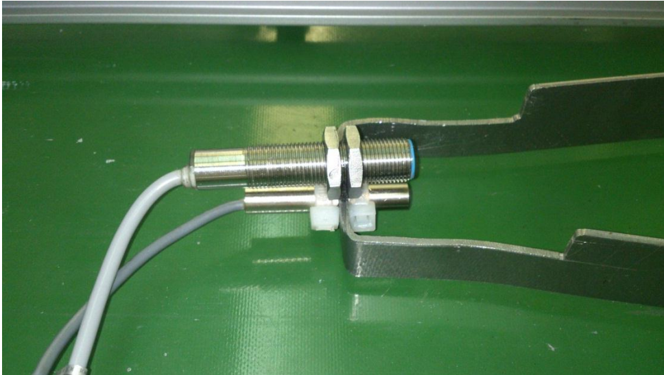
Slika 37: Ustavljalna rampa s senzorji
