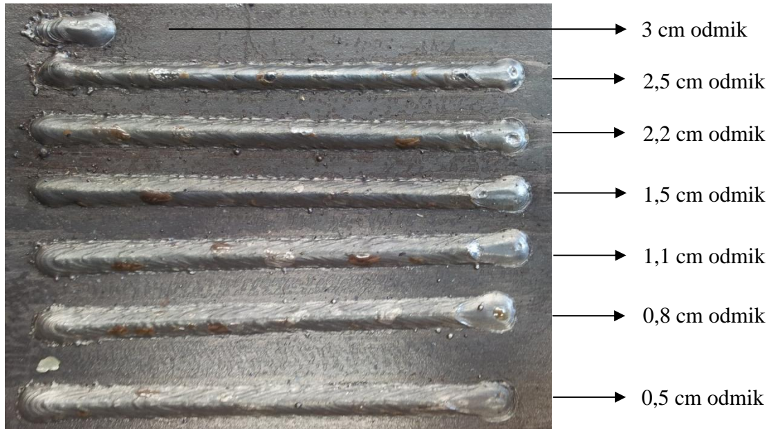
Slika 31: Zvari z različnimi odmiki pištrole
