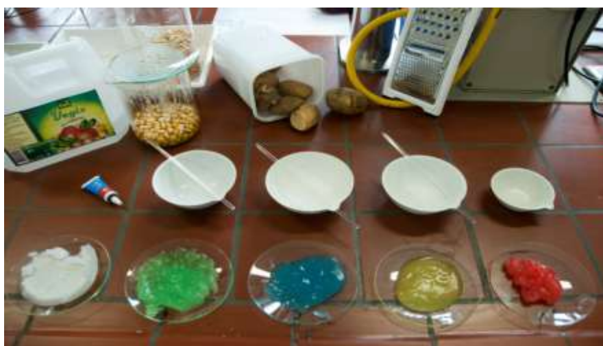
Slika 6: Sestavine za izdelavo bioplastike in izdelana bioplastika (foto: Pia Klančar, 2012)
