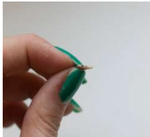
Vrsta bioplastike: Iz izoliranega škroba Vrsta prsti: biopost Datum: 12.1.2013
