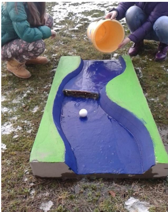
Slika 13: Merjenje časa potovanja merilne žogice po modelu sonaravne struge.
