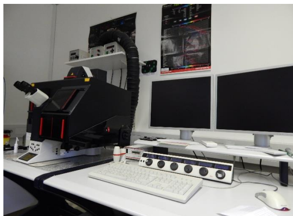
Slika 35: Fluorescenčni laserski mikroskop Leica TCS SP5 na Kemijskem inštitutu v Ljubljani (Foto: N. Kejžar)
