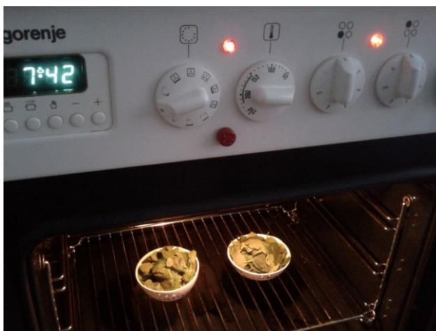
Slika 2: Sušenje mete v pečici na 105 °C za določanje suhe snovi (Vir: osebni arhiv)
