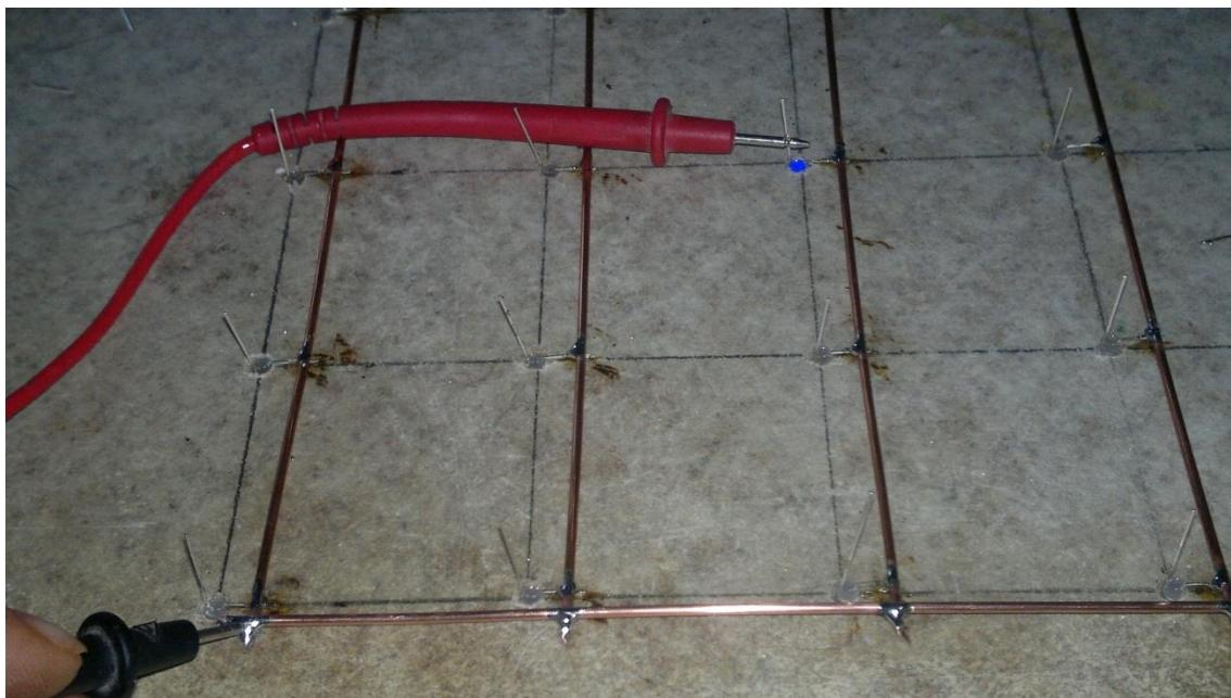
**Slika 25: Test vsake diode na ploskvi**
