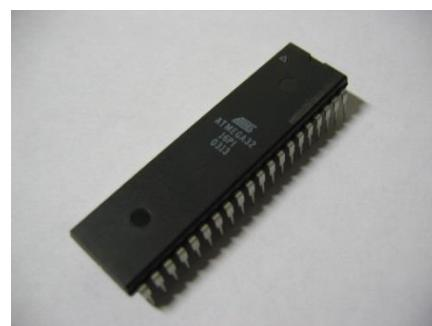
**Slika 12: Mikrokrmlnik ATmega32**Vir: [http://commons.wikimedia.org/wiki/File:Atmel\\_atmega32\\_mikrokontrolleri.jpg](http://commons.wikimedia.org/wiki/File:Atmel_atmega32_mikrokontrolleri.jpg)
