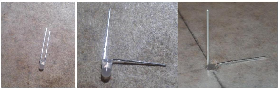
**Slika 19: Priprava in vstavljanje LED diode**
