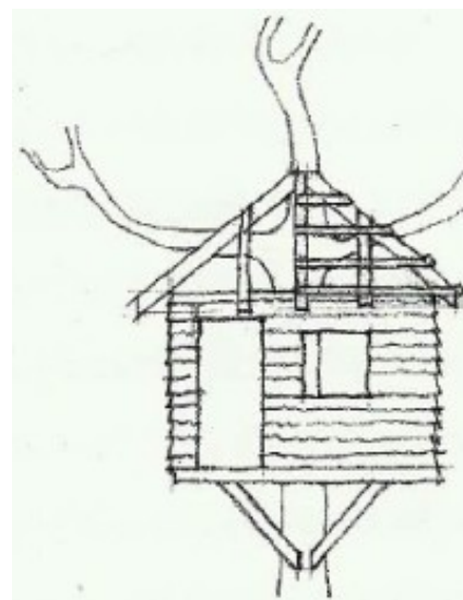
Slika 10: Postavitev špirovcev in pokrivanje z letvami
