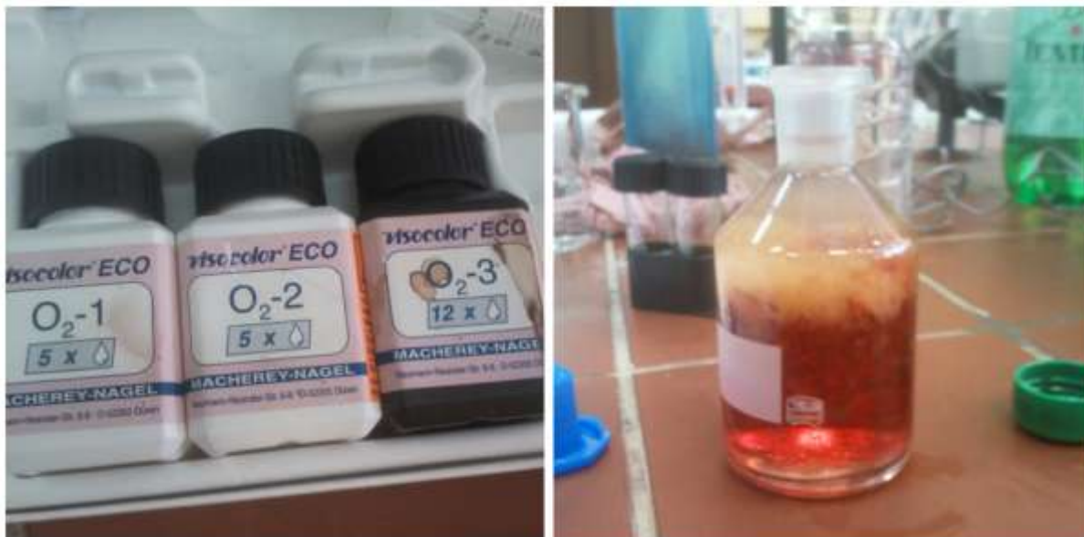
Slika 16: Določevanje vsebnosti kisika s hitrimi testi
