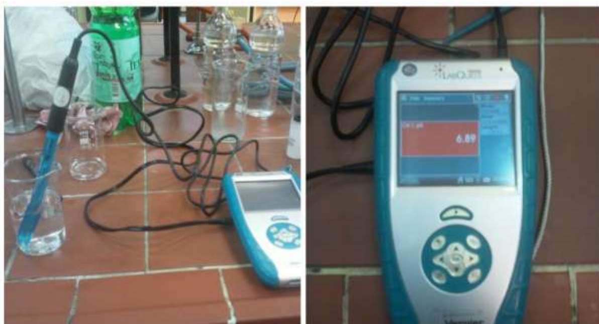
Slika 15: Merjenje vrednosti pH z napravo vernier
