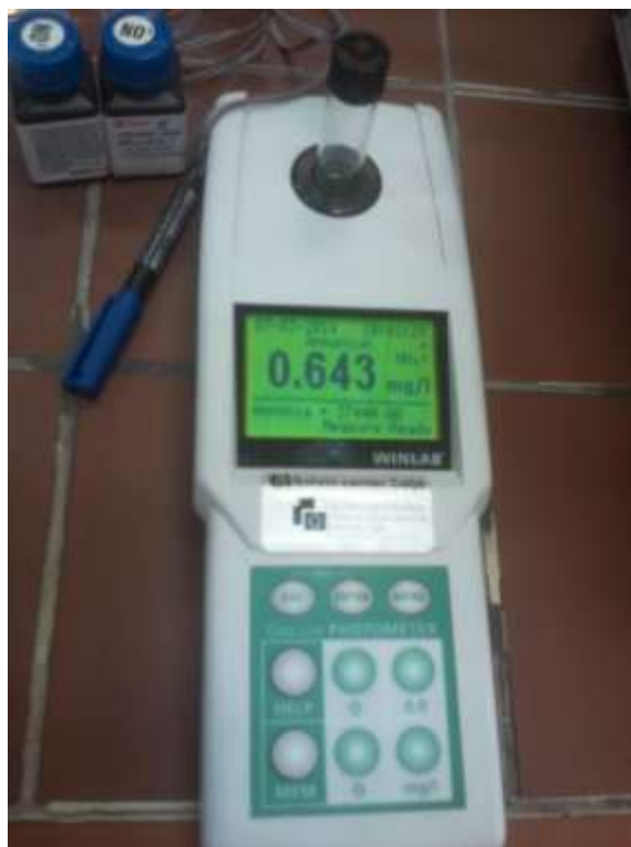
Slika 19: Rezultat vsebnosti amonija v enem od vzorcev vode
