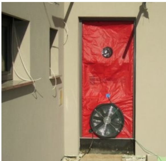
Slika 57: ventilator Blower door
